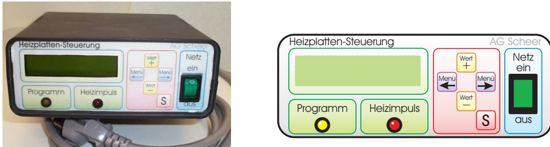
Abbildung 3.4: Fertiges Steuergerät und Geräte-Frontplatte (Maßstab 1:2). In den Menüfeldern kann man Parameter verändern (mit + und -), speichern oder den Prozess starten oder stoppen (jeweils mit Taste „S“).
