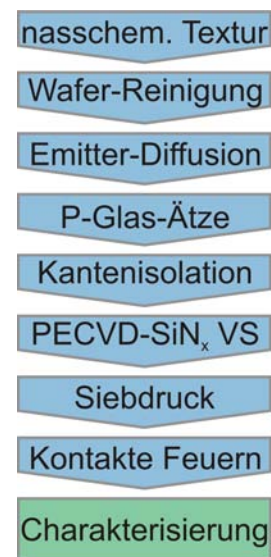
Abbildung 2.2 Prozessdiagramm eines in der Industrie angewendeten Herstellungsprozesses für Silizium-Solarzellen.
