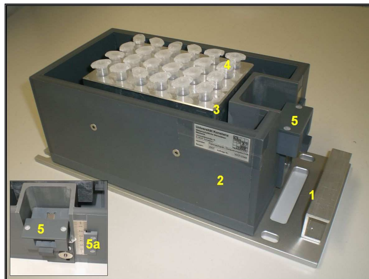
Abb. 13 Eisbox für 2-ml-Eppendorf-Reaktionsgefäße. 1) Träger für die Eisbox/ 2) Eisbox/ 3) Metallträger für die Reaktionsgefäße/ 4) Reaktionsgefäße/ 5) Halter für den Dosimetersensor; 5a) Lineal, um den Sensor zu positionieren (Konstruktionsentwurf von Dipl. Biol. Thilo Sindlinger)
