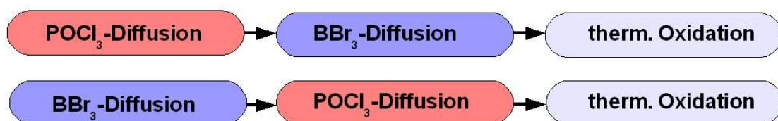
Abb. 3.25: Prozesssequenzen für Lebensdauermessungen. Für die \text{POCl}_3 -Diffusion wurde der Prozess bei 900^\circ\text{C} für einen R_{\text{sheet}} von 20 \Omega/\text{sq} verwendet, bei der \text{BBr}_3 -Diffusion handelt es sich um die 90 \Omega/\text{sq} -Diffusion mit in-situ Oxidation der BRL.
