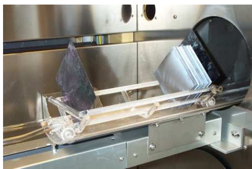
Abb. 3.3: Links: ein mit Si-Wafern beladenes Quarzboot des Diffusionsofens, rechts: schematischer Aufbau eines „open-tube“-Diffusionsofens.
