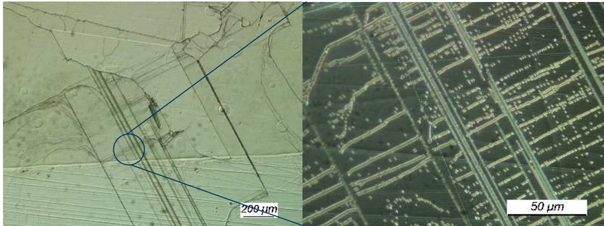
Abb. 1.24: Optische Aufnahme einer Probe aus der Mitte von Block 2 nach Behandlung mit einer Schimmel-Ätzlösung zum Sichtbarmachen der Defekte – rechts ein vergrößerter Ausschnitt (ohne P-Gettern).
