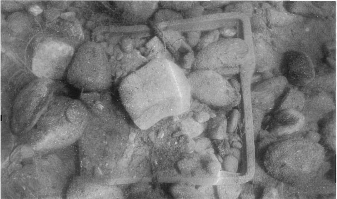
Abbildung 5. Mit Standortsubstrat gefüllter Kunststoffkorb der Variante KK am Expositionsort (Foto am 23.3.1995, Pegel Konstanz 3,07 m).
