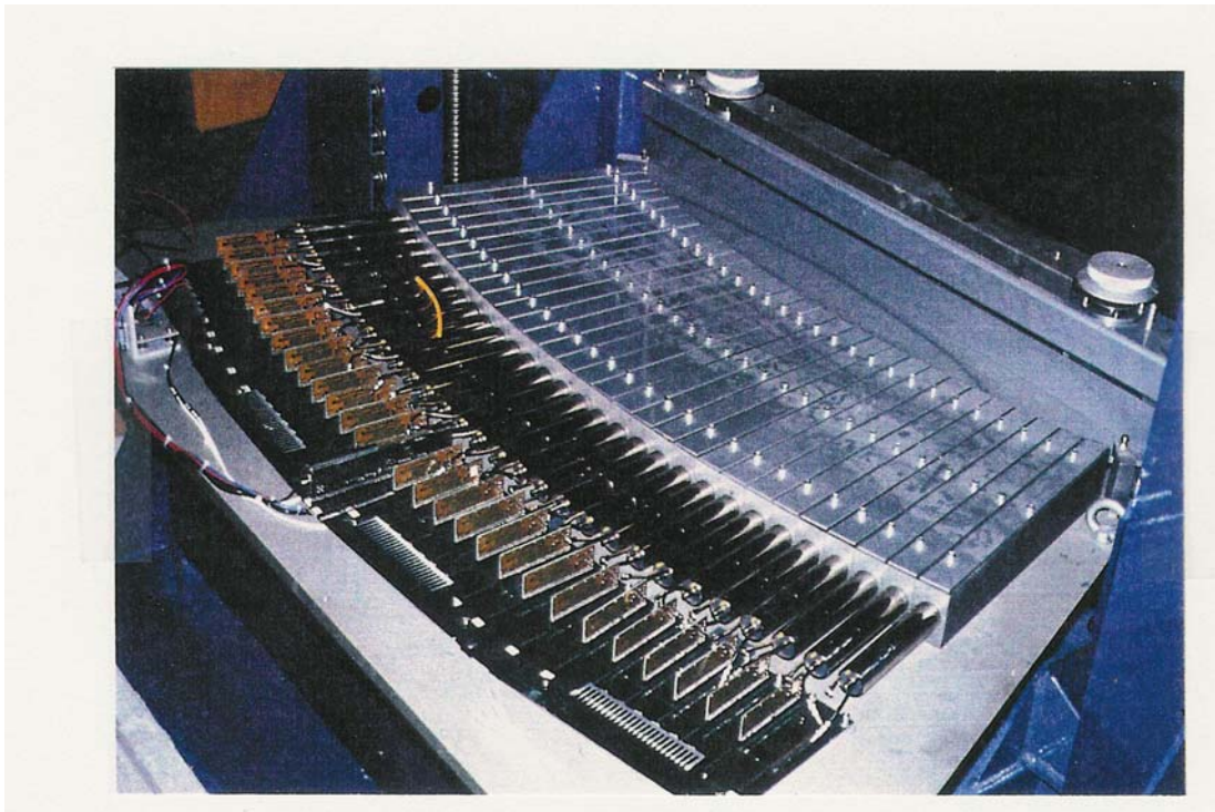
Abbildung 3.5 Detektorfächer der industriellen CT-Anlage in Garching. Die Detektorbank umfaßt 30 Plastikszintillationszähler innerhalb eines Wolfram-Kollimatorblocks.
