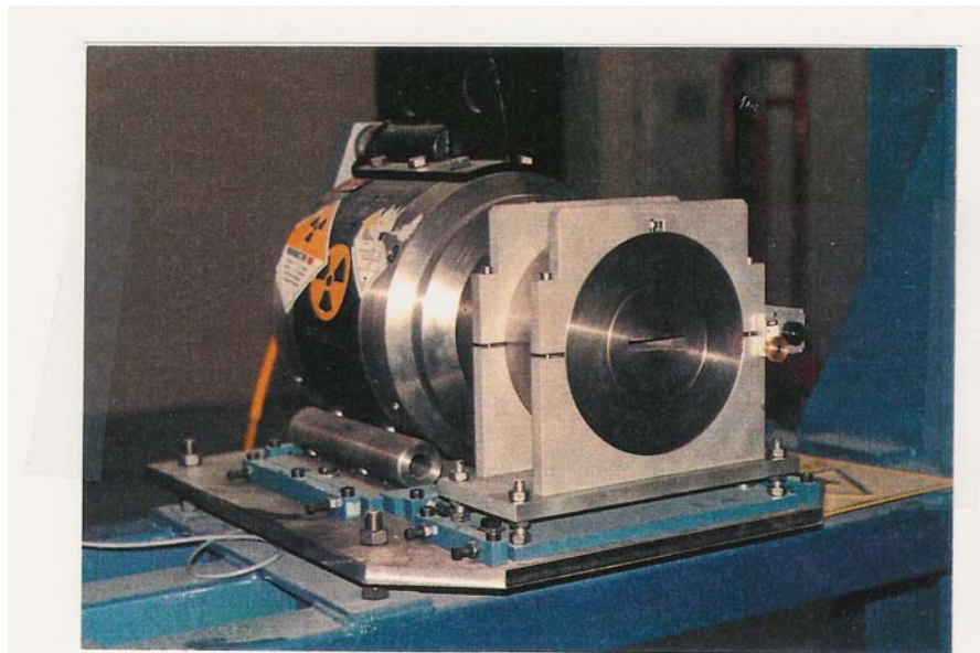
Abbildung 3.4 ^{60}\text{Co} -Radionuklidquelle des Groß-Computer-Tomographen in Garching. Aufsicht von vorne auf den Wolfram-Fächerstrahlform-Kollimator. Das radioaktive Kobalt liegt als metallische Pille von etwa 7 mm Durchmesser im Inneren des Abschirmbehälters. Dieser ist aus abgereichertem Uran (= ^{238}\text{U} , Dichte = 18,90 \text{ g/cm}^3 > \text{Dichte}(\text{Blei}) = 11,4 \text{ g/cm}^3 ) innerhalb einer Edelstahlhülle. Der gesamte Transportbehälter von ca. 50 cm Länge wiegt 384 kg. Die Aktivität der Quelle betrug zur Zeit der Experimente 8,14 \cdot 10^{12} \text{ Bq} (220 Ci; T_{1/2}(\text{Co}^{60}) = 5,27 \text{ a} ).
