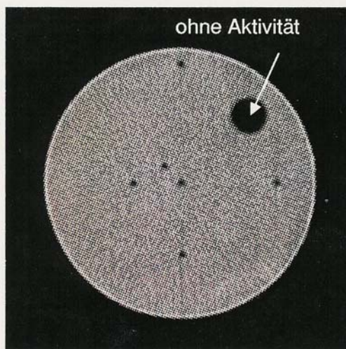
Transmissions-Computer-Tomogramm (TCT) (360 Winkel x 512 Schritte) zur Darstellung der Dichteverteilung
