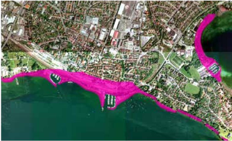
Abbildung 16: Rekonstruktion der Uferaufschüttungen am südlichen Ortsrand von Radolfzell sowie im Bereich des westlichen Markelfinger Winkels. Die landseitige Ausdehnung wurde anhand von archäologischen Grabungsbefunden, der mittelalterlichen Bausubstanz, älteren Stadtplänen und alten Ansichten des 19. und 20. Jahrhunderts, Plänen der badischen Eisenbahnverwaltung um 1860, des Altlastenkatasters beim Landkreis Konstanz sowie anhand des stellenweise noch sichtbaren natürlichen Uferreliefs rekonstruiert (Luftbildgrundlage mit freundlicher Genehmigung des Landesamtes für Geoinformationen und Landentwicklung Baden-Württemberg).
