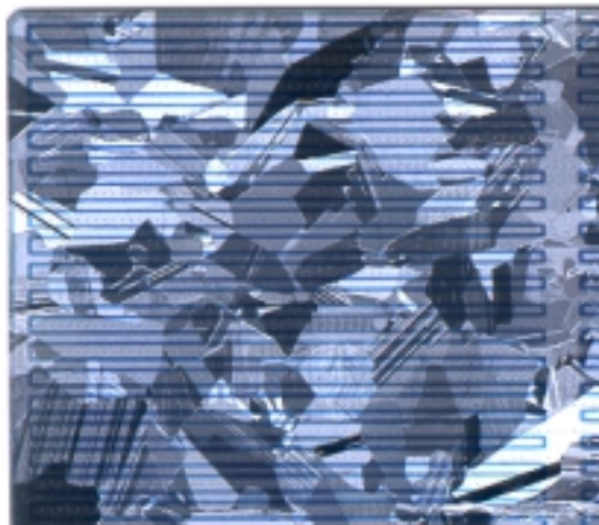
Fig. 29: Ausschnitt aus einer 10 \times 10 \text{ cm}^2 Zelle, bei der die Diffusionsbarriere aufgedruckt und ge feuert wurde. Die Kontakte fehlen noch. Die Barrierenpaste bedeckt nur einen schmalen, mäanderförmigen Streifen zwischen Basis- und Emitterbereich. Die unmittelbar nach dem Druck farblose Schicht wird nach dem Feuern dunkelblau; der Druck der Kontakte kann dadurch – wenn nötig – nachjustiert werden.
