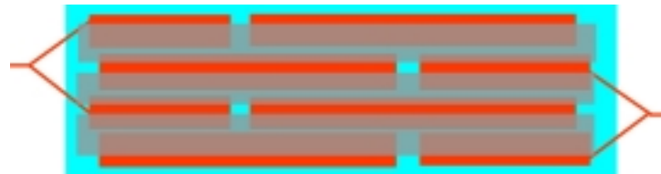
Fig. 102: Modulrückseite aus einer Glasfaserplatte mit breiten Leiterbahnen, die durch eine isolierende Schicht (Lack oder Folie) von den Fingern des jeweils anderen Kontakt elektrisch getrennt sind.
