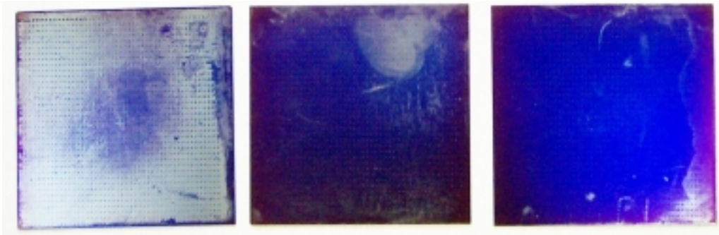
Fig. 48: Fotos dreier Zellen, die vor dem Feuern der Kontakte mit einer Siliziumnitrid ARC beschichtet wurden, die sich während dem Feuern teilweise ablöst (sog. Blistering). Mögliche Ursache sind Rückstände, die sich während dem Plasmaätzen der Rückseite auf der Frontseite ablagern und die zum Abplatzen des SiN bei hohen Temperaturen führen.
