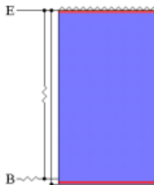
Fig. 107: Eindimensionales Modell des Simulationsprogramms PC1D. Ein rückseitiger Emitter läßt sich zwar einbauen, nicht jedoch der pn-Übergang an der rückseitigen Oberfläche. Shunt und Serienwiderstände können extern angehängt werden.
