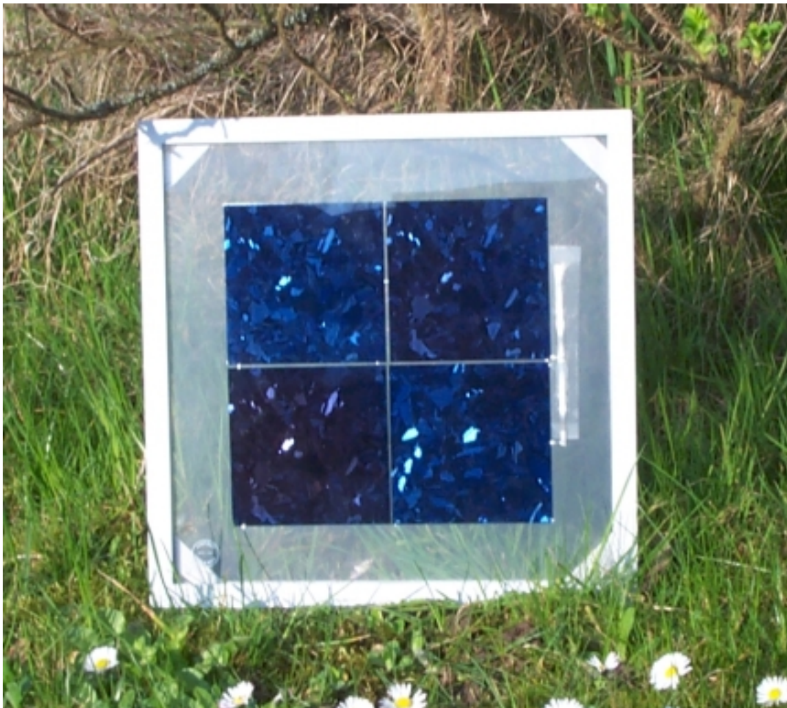
Fig. 104: Minimodul mit vier mechanisch texturierten EWT-Zellen aus multikristallinem Silizium.
