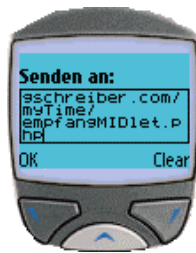
Abbildung 44: Senden An... - Unter diesem Menüpunkt kann man festlegen, an welche Server URL die Daten geschickt werden sollen
