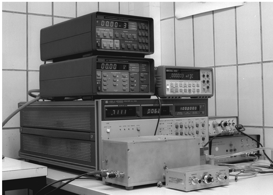
Abb. 2.4: Der CV-Meßstand im Oberflächen-Charakterisierungslabor. Das größte Gerät in der Mitte ist der HP 4192 A LF Impedanz-Analysator. Davor befindet sich die Probenzelle und ganz vorne das Strom-Elektrometer.
