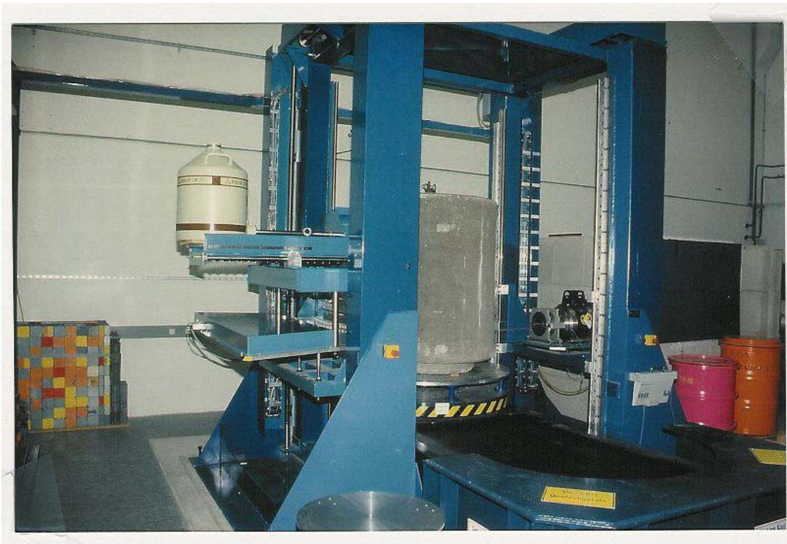
Abbildung 5.10 Foto der CT-Anlage nach Erweiterung für Emissions - und Streustrahlungsmessung. Links oben im Bild der Flüssigstickstofftank des HPGe-75 Detektor. Darunter der Plastikszintillatorfächer; rechts innerhalb des Säulenportals die 60 Co-Strahlungsquelle für Transmissions-CT und Digitale Radiographie.
