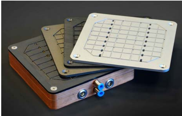
Abbildung 8.11: Messblock mit austauschbarer Deckplatte zur Variation der Reflexion.
