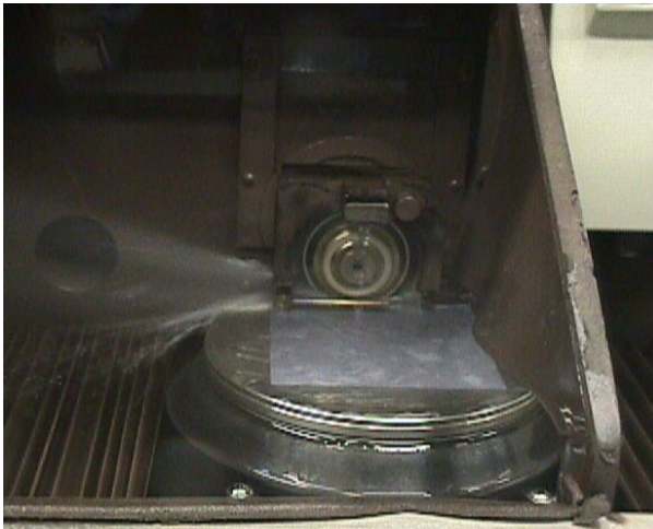
Abb. 2.1: Mechanische Texturierung. Die Grafiken oben (gezeichnet von Gerd Willeke) zeigen das Prinzip von Einzelblatt-, Multiblatt- und Walzentexturierung. Schnell rotierende, V-förmig angespitzte Sägeblätter oder Texturierungswalzen fräsen Gräben aus dem Silizium. Die Fotos unten zeigen die vom Autor verwendete programmierbare Sägemaschine 'Disco DAD 320'. Das linke Bild zeigt die Maschine beim Texturieren eines 10 \times 10 \text{ cm}^2 Wafers mit einem Einzelblatt. Der Wafer wird durch ein Vakuum auf dem bewegten Sägeblatt gehalten, das Sägeblatt ist auf einer Spindel montiert und rotiert mit 30000 U/min. Deutlich sichtbar ist das Wegspritzen des Kühlwassers. Das rechte Bild zeigt die gesamte Sägemaschine.
