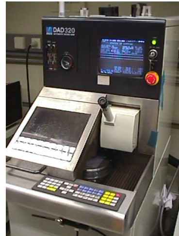
Abb. 2.1: Mechanische Texturierung. Die Grafiken oben (gezeichnet von Gerd Willeke) zeigen das Prinzip von Einzelblatt-, Multiblatt- und Walzentexturierung. Schnell rotierende, V-förmig angespitzte Sägeblätter oder Texturierungswalzen fräsen Gräben aus dem Silizium. Die Fotos unten zeigen die vom Autor verwendete programmierbare Sägemaschine 'Disco DAD 320'. Das linke Bild zeigt die Maschine beim Texturieren eines 10 \times 10 \text{ cm}^2 Wafers mit einem Einzelblatt. Der Wafer wird durch ein Vakuum auf dem bewegten Sägeblatt gehalten, das Sägeblatt ist auf einer Spindel montiert und rotiert mit 30000 U/min. Deutlich sichtbar ist das Wegspritzen des Kühlwassers. Das rechte Bild zeigt die gesamte Sägemaschine.
