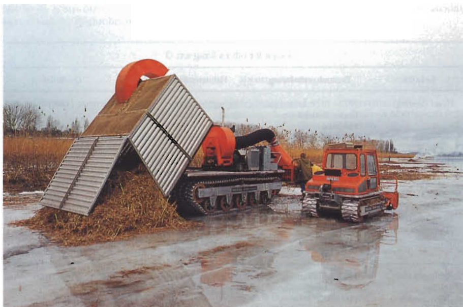
Abb. 25. Schilfschnitt am Bodensee-Untersee: Mähraupe mit Container beim Entleeren des Mähgutes; rechts daneben kleine Mähraupe, beides Geräte der Fa. Mulag. – Foto W. OSTENDORF.
