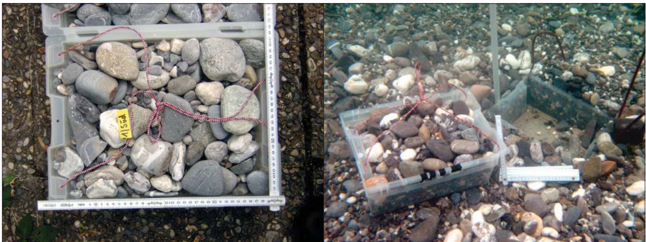
Abb. 1: Container zur Ermittlung des Feinmaterialeintrags: (a) links – fertig befüllter Container an Land, (b) rechts – Container unter Wasser unmittelbar vor dem Einsetzen in den Platzhalter-Container; die Kies- und Geröll-Oberfläche schließt ebenerdig mit der Umgebung ab (Foto: J. Köninger).
