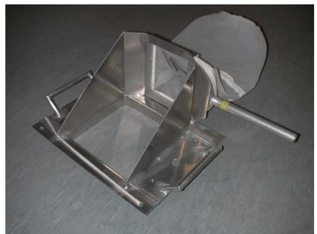
Abb. 7: Probennahmegerät für strömende Untersuchungsstellen.
