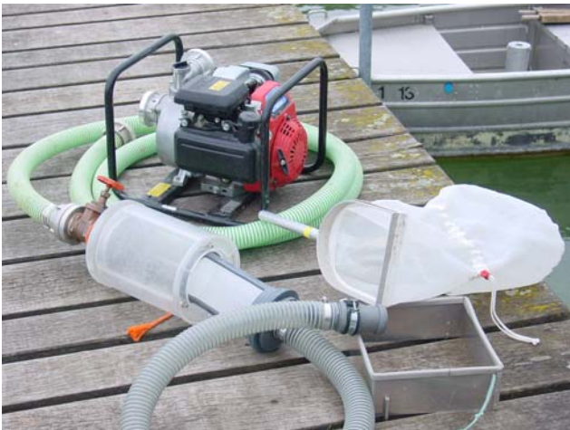
Abb. 6: Infralittoral-suction-sampler ISS. Innerhalb des Metallrahmens erfolgt die Probennahme. Harte Substrate werden direkt in den Kescher gegeben, während mobile Organismen in den Fangkorb des samplers gesaugt werden.
