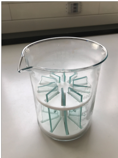
Abbildung 50 Oben: Zeichnung der Probenkammer Unten Links: Messzellen in der Waschalterung Unten Rechts: 1.) 3D Modell. 2.) Glaskorpus der Probenkammer. 3.) fertig befüllte Probenkammer, auf beiden Seiten ist mit Zweikomponentenkleber ein 18x18 mm 2 großes Deckglas befestigt worden.
