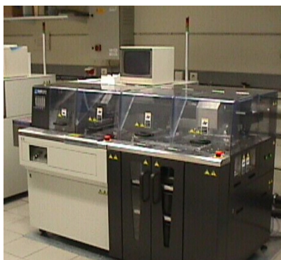
Abbildung 4.13: a) DISCO DAD 341solar, die erste vollautomatische Texturierungsanlage. b) Texturierungsanlage für hohen Durchsatz, die vom FhG IPT entwickelt wurde.
