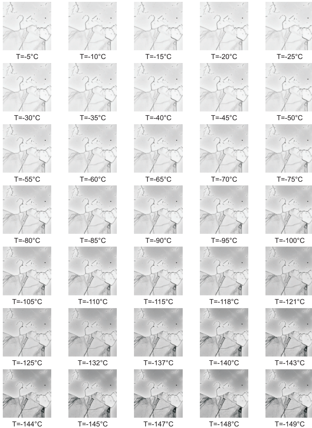
Abbildung B.1: EBIC-Bilder ( 2,5 \times 2,5 \text{ mm}^2 ) von Probe 1 (as grown) entsprechend der Experimentbeschreibung aus Abschnitt 3.1.2. Die Bilder haben alle dieselben Kontrastwertgrenzen.
