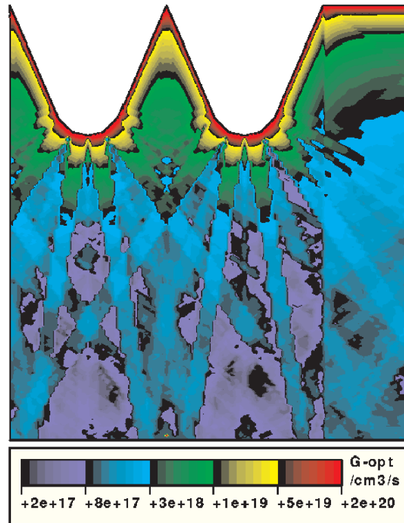
Abbildung 5.21: Generationsprofil für senkrechten Lichteinfall auf eine V-texturierte Solarzelle. Ein Großteil der Ladungsträger wird im Bereich der V-Spitze generiert [153].
