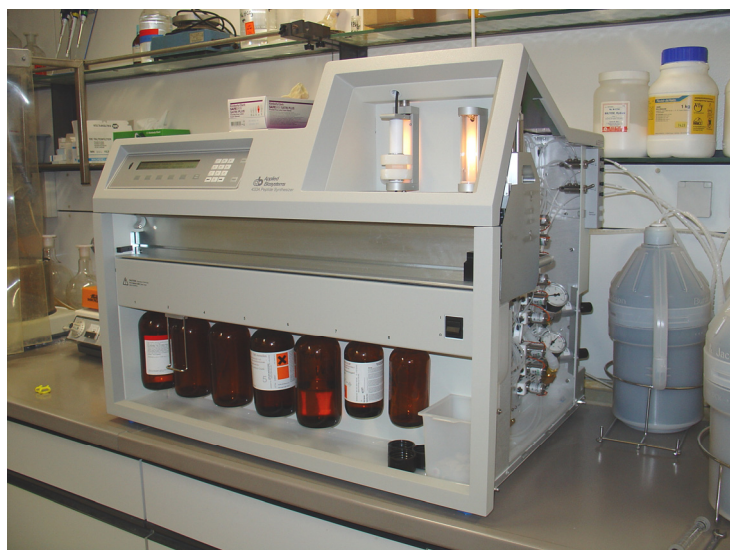
Abbildung 56. Peptidsynthesizer ABI 433A der Firma Applied Biosystems. Zu sehen sind: Eingespanntes 3-mL-Reaktionsgefäß aus Teflon (oben), Schlitten zum Einsetzen der Aminosäure-Kartuschen (Mitte), Vorratsflaschen mit Reagenzien (unten) und Vorratsflaschen mit Lösungsmitteln (rechts vom Gerät).
