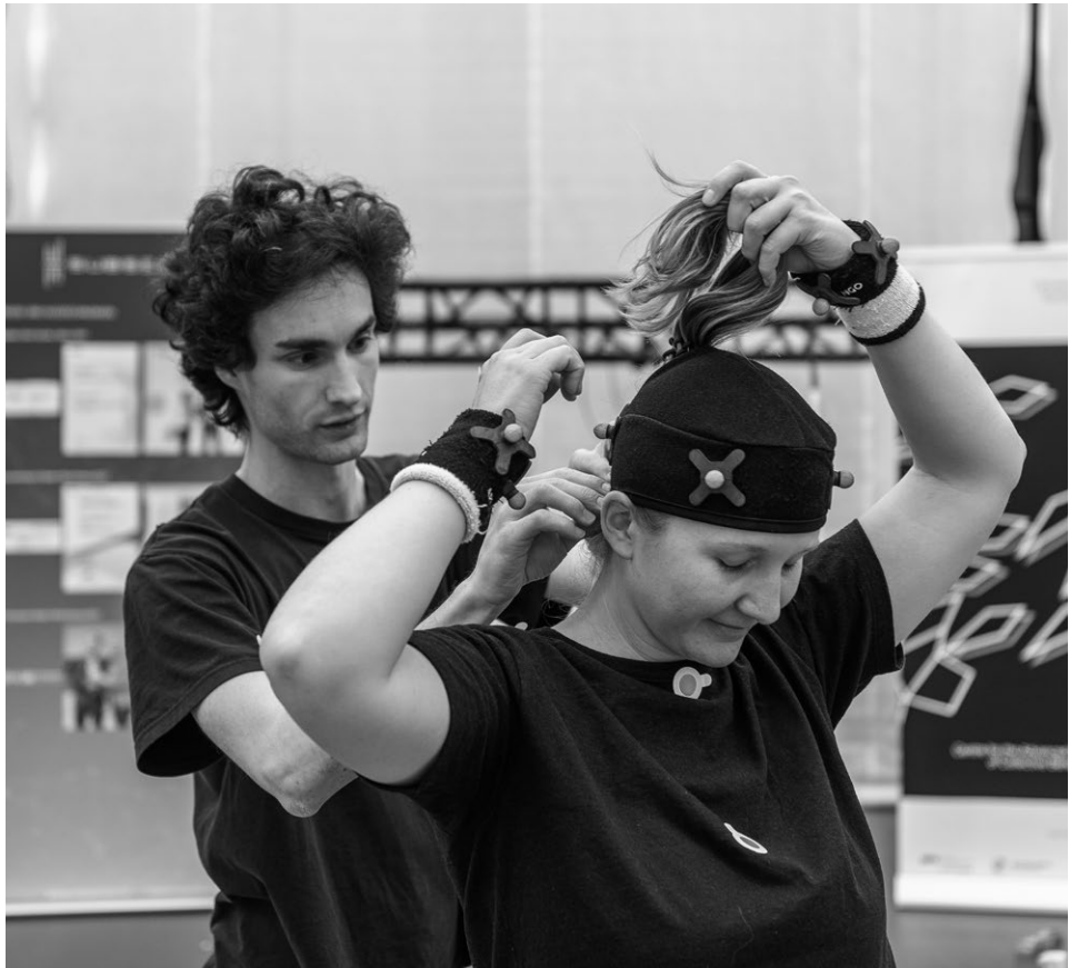
Philip Zimmermann, Chief Technology Officer (CTO) der Subsequent GmbH, befestigt Reflektoren an der Kleidung der Sportlerin, um anschließend per Motion Capturing deren Bewegung im Raum genau nachverfolgen zu können.
