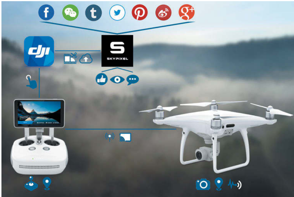
Abb. 3: Ensemble aus Drohne, Controller, Smartphone, Apps und sozialen Plattformen am Beispiel einer DJI Phantom. (eigene Grafik).
