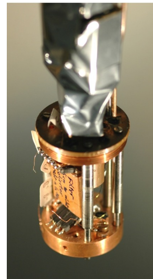
Abbildung 4.4.: unteres Ende des Kryostats mit Bruchmechanik, Filterarray und eingesteckter Probe.
