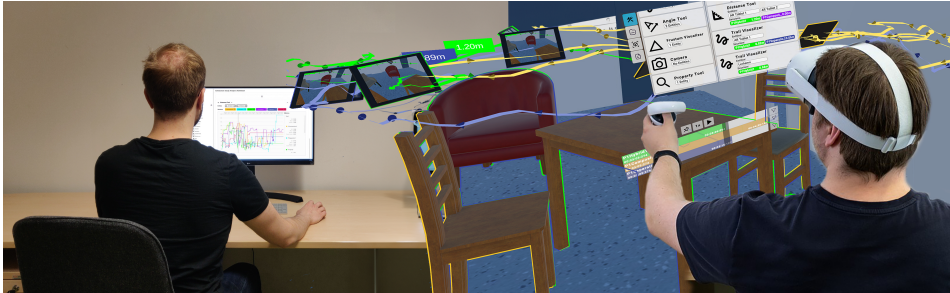
Abb. 5: Ein kollaboratives Complementary Interface basierend auf RELIVE ermöglicht Analysten die gemeinsame Analyse von Studiendaten: Einer nutzt eine 2D-Desktop-Ansicht, während ein anderer gleichzeitig dieselben Daten als 3D-Trajektorien in einer immersiven Umgebung betrachtet. Eine Datensynchronisierung erlaubt flexible kollaborative Aktivitäten und nahtlose Übergänge.
