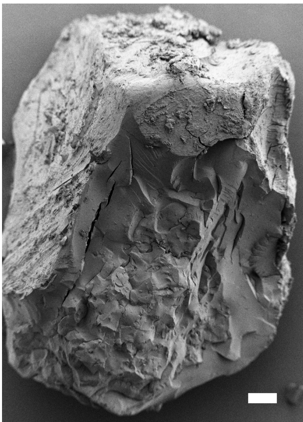
Abbildung 55. MPS-5.4 Partikel nach dem ESR-Bildgebungsexperiment und Entnahme aus dem Schrumpfschlauch (Maßstab 200 \mu m). Oben ist die Seite von der aus die TEMPONE-Lösung aus einer Kapillare durch den Partikel diffundiert ist. (Für die weiteren Partikel siehe Kapitel 7.4.3.9)
