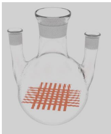
Abb. 5.34: Kolben mit eingebautem Kupfergitter für die Gasphasen-Silica Reaktion. Im Kolben wird TEOS vorgelegt, auf das Gitter kommt ein Stück der Bioprobe (Halm oder Blatt), und unter Rückfluss entlang der Kolbenwand wird TEOS verdampft.
