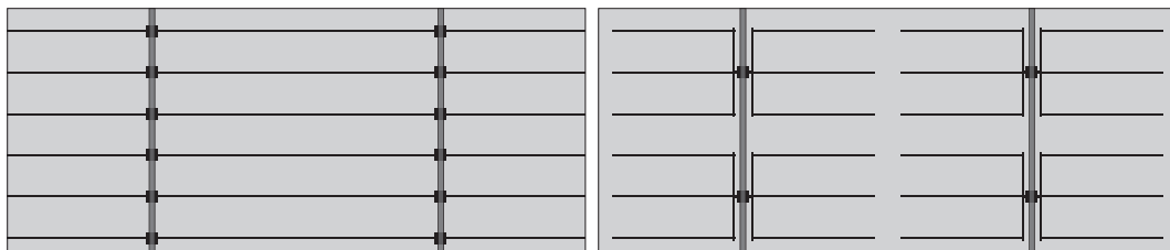
Abb. 5.14: Schematischer Ausschnitt der zwei Gridstrukturen mit Fingern und Vorderseitenpads (schwarz). In Grau sind die Drähte dargestellt. Links: Standardgrid, jeder Finger wird mit Vorderseitenpads kontaktiert, die Finger sind durchgängig. Rechts: Optimiertes Grid mit Fingerunterbrechungen und reduzierter Vorderseitenpadanzahl.
