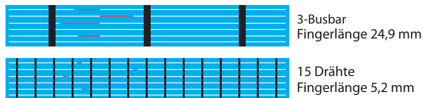
Abb. 1.10: Aufsicht auf eine 3-Busbar und eine Multi-Busbar-Solarzelle mit 15 Drähten. Fingerunterbrechungen können bei 3-Busbar-Solarzellen den Serienwiderstand stark erhöhen (oben). Bei Multi-Busbar-Solarzellen ist dieser Effekt nicht ausgeprägt, da die effektive Fingerlänge gering ist (unten). In Rot jeweils die erhöhte effektive Fingerlänge.
