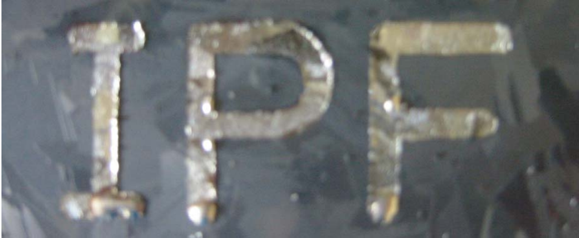
Abbildung 5.6: LPE-Schicht auf den nicht mit \text{SiO}_x bedeckten Stellen einer Waferrückseite. Es sind noch kleine Tröpfchen Indium zu erkennen, welche beim entladen auf der LPE-Schicht verblieben sind. Diese können mit Hilfe von Königswasser problemlos entfernt werden.
