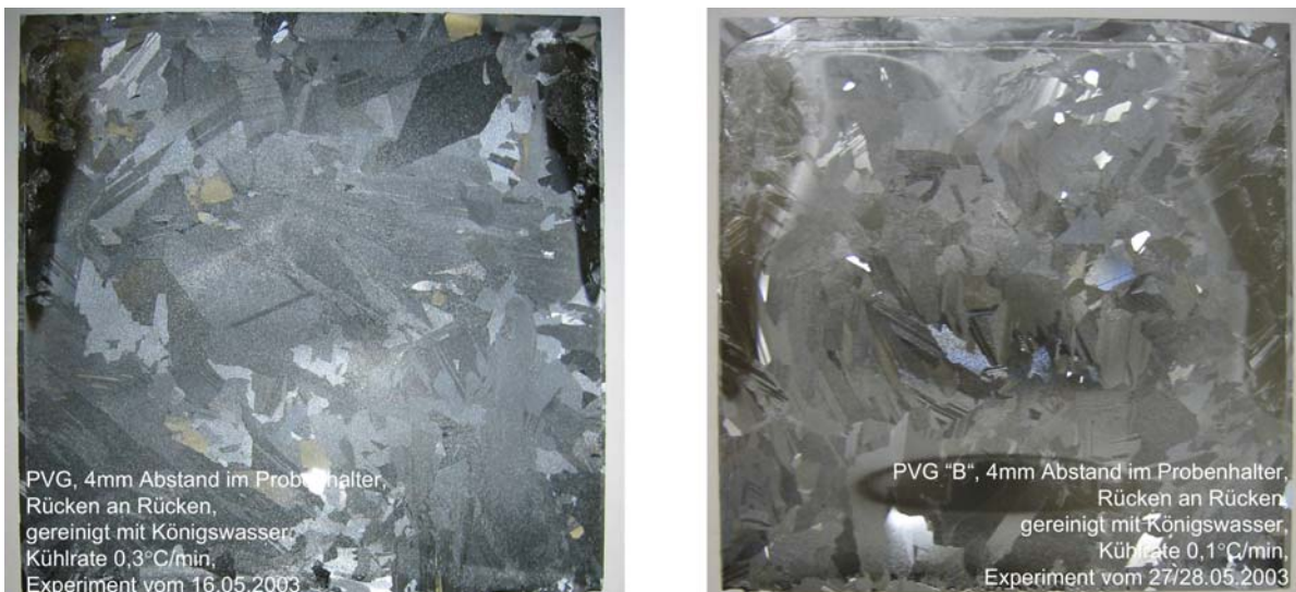
Abbildung 5.9: Inhomogenitäten auf PVG Wafern mit LPE Schicht nach Prozessierung
