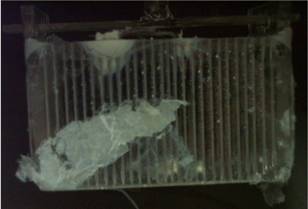
Abbildung 5.7: Quarzprobenhalter für 25 cm^2 Wafer mit grauer Schlacke, vermutlich Indiumoxid.
