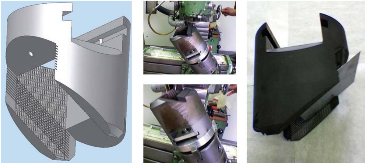
Abbildung 5.19: Idee, Realisierung des schrägen Probenhalters durch die mechanischen Werstätten der Universität Konstanz, Ergebnis
