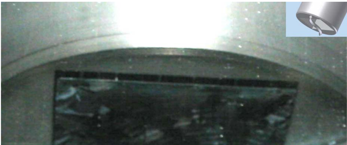
Abbildung 5.20: horizontaler Wafer zwischen Rührer und vertikalen Wafern zur Verhinderung einer Indiumbedampfung der übrigen Wafer
