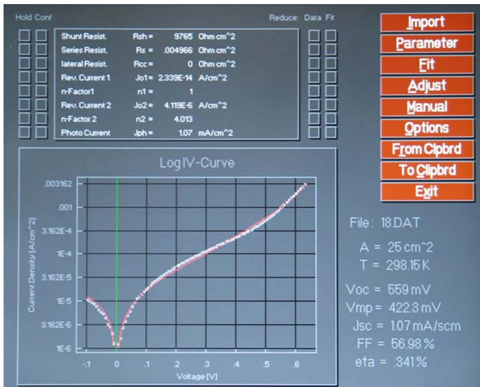
Abbildung 6.18: Rechnerischen Näherung durch Simulation an eine gemessene I-V-Kennlinie.
