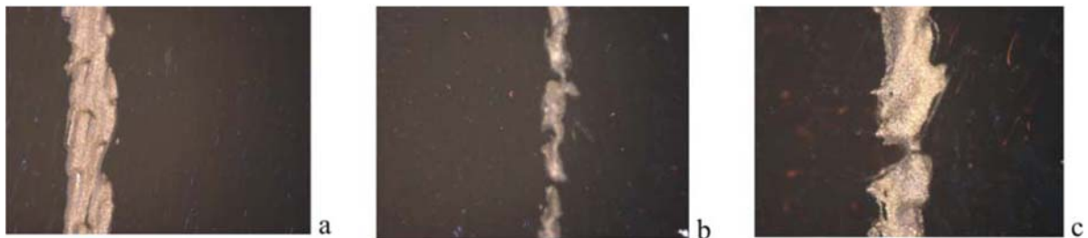
Abbildung 6.4: Unterbrechungen im Ag-Frontgriddruck auf großflächiger LPE-Schicht
