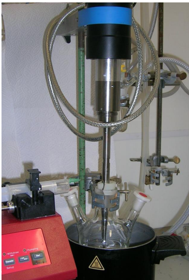
Abb. A 2: Aufbau der Wasser-in-Öl-Emulsionssynthese für ZnO-Nanopartikel.
