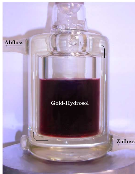
Abbildung 3.2: Doppelwandiges Reaktionsgefäß zur Herstellung von Metall-NP. In der inneren Reaktionskammer befindet sich Gold-Hydrosol mit 20 nm durchmessenden NP. Die innere Reaktionskammer wird von einem Wasser-Glycerin-Gemisch bei konstanter Temperatur von ca. 105 ° umspült. Die so geschaffene homogene Temperaturverteilung in der Gold-Lösung und eine starke Verwirbelung sorgen für eine gleichmäßige Reduktionsrate der Goldionen im gesamten Volumen. Dadurch lässt sich in gewissen Grenzen die Größenverteilung der Gold-NP kontrollieren.
