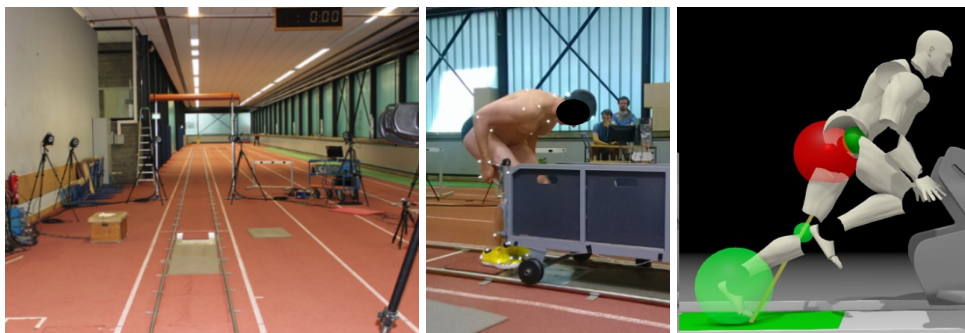
ABB. 1: MESSAUFBAU FÜR LEISTUNGS- UND BELASTUNGSANALYSEN IM BOBSPORT; LINKS: 80 M ANSCHUBSTRECKE UND MESSBEREICH MIT KAMERAS UND KRAFTMESSPLATTEN; MITTE: ATHLET UND MESSBOB VOR ABRISS; RECHTS: VISUALISIERUNG POSITIVER (GRÜN) UND NEGATIVER (ROT) MECHANISCHER LEISTUNG AN DEN GELENKEN UND AM KÖRPERSCHWERPUNKT.
