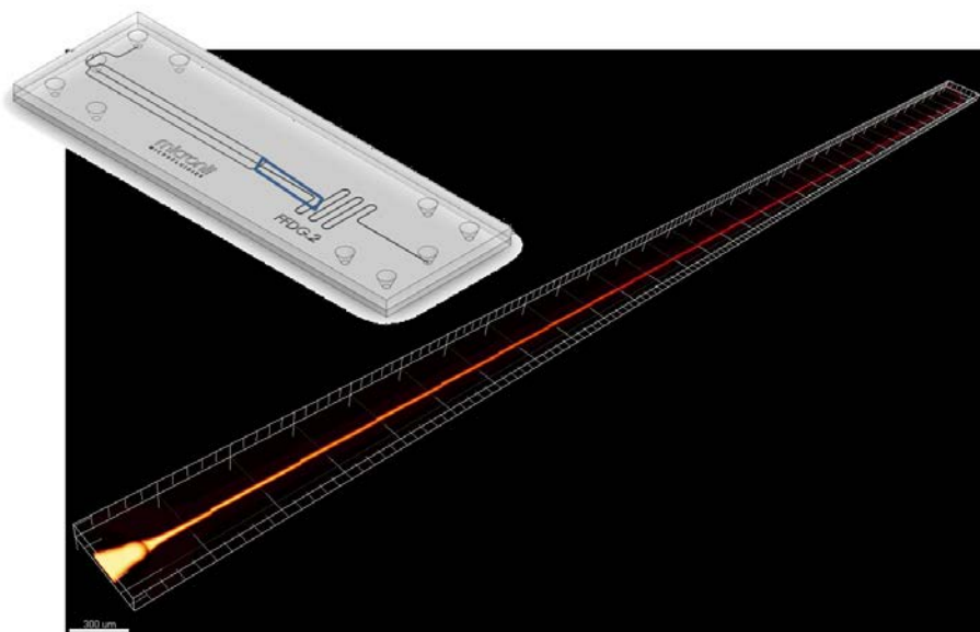
Abbildung 3-51 Visualisierung des Mischverhaltens von THF und Wasser in einem mikrofluidischen Chip mit Hilfe der CARS-Mikroskopie. Scale bar: 300 \mu\text{m} .
