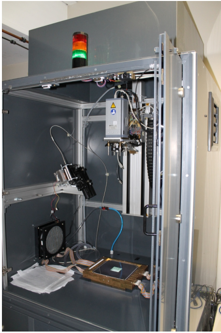
Abbildung 3.12: Konstanzer Eigenbau eines Lumineszenzmessplatzes. [34]
