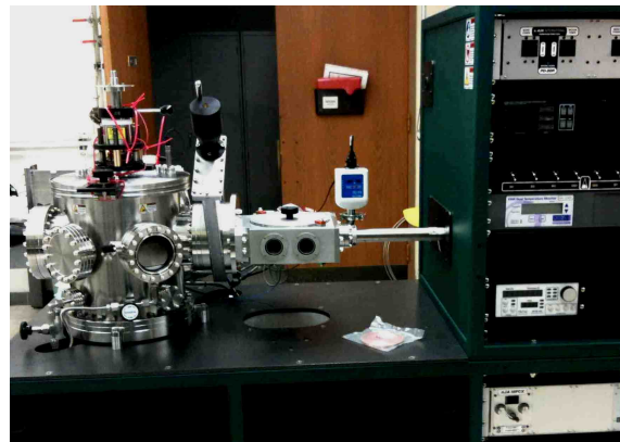
Abbildung 3.3: Sputteranlage der Firma AJA International der Modellreihe ATC Orion. [10]
