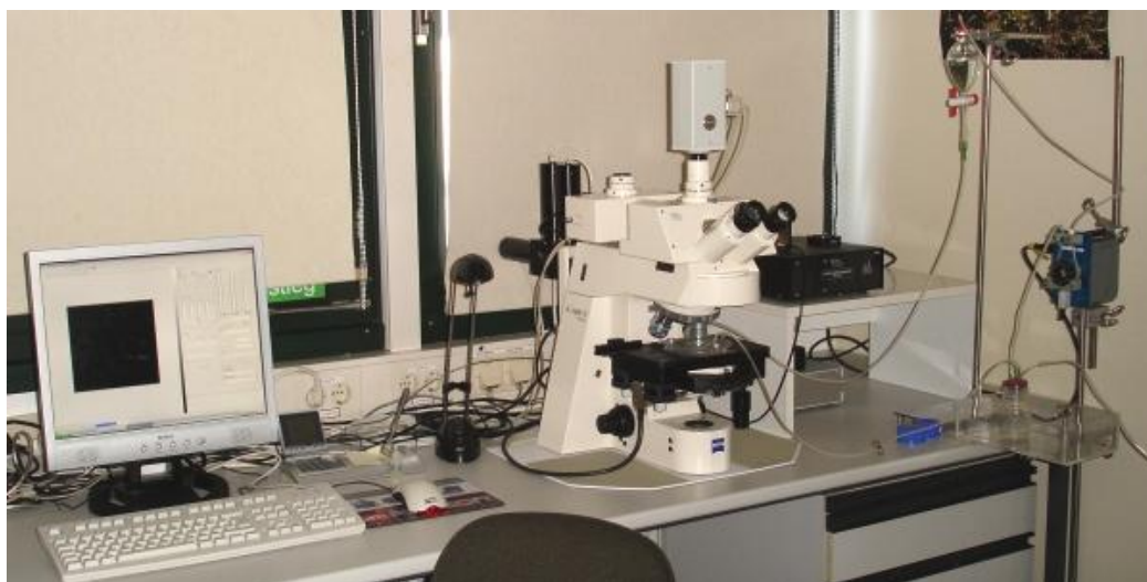
Figur 2.2.2.1: In der Mitte im Bild ist das modifizierte FKM (Kupper, Ferimazova et al. 2004). Via Glasfaserkabel verbunden, befindet sich rechts davon das Spektrometer. Die Geräte werden mittels PC durch die Programme Fluorcam6 (FKM), bzw. spectrum gesteuert. Die spezielle Messkammer (Fig. 2.2.1.1a) ist auf dem Objekttisch des FKM fixiert. An ihr ist ein Mediumkreislauf angeschlossen (Fig.
