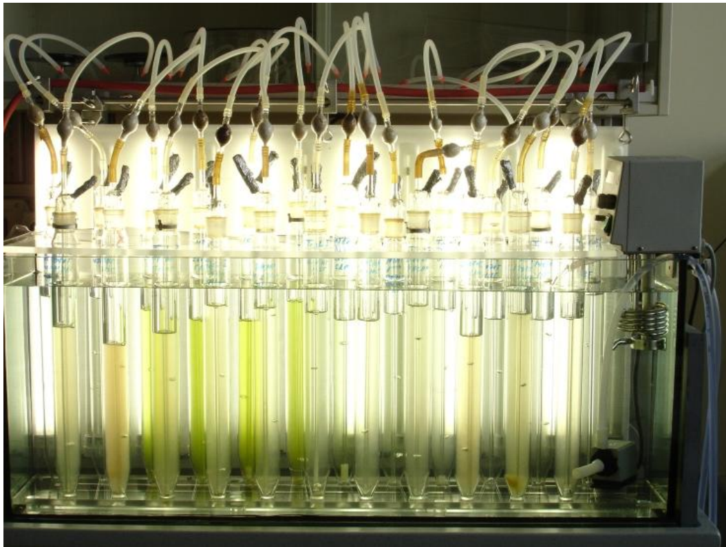
Figur 2.1.2.1: Temperiertes Glasaquarium zur Batch-Kultivierung von Trichodesmium vor einer Lichtleiste
