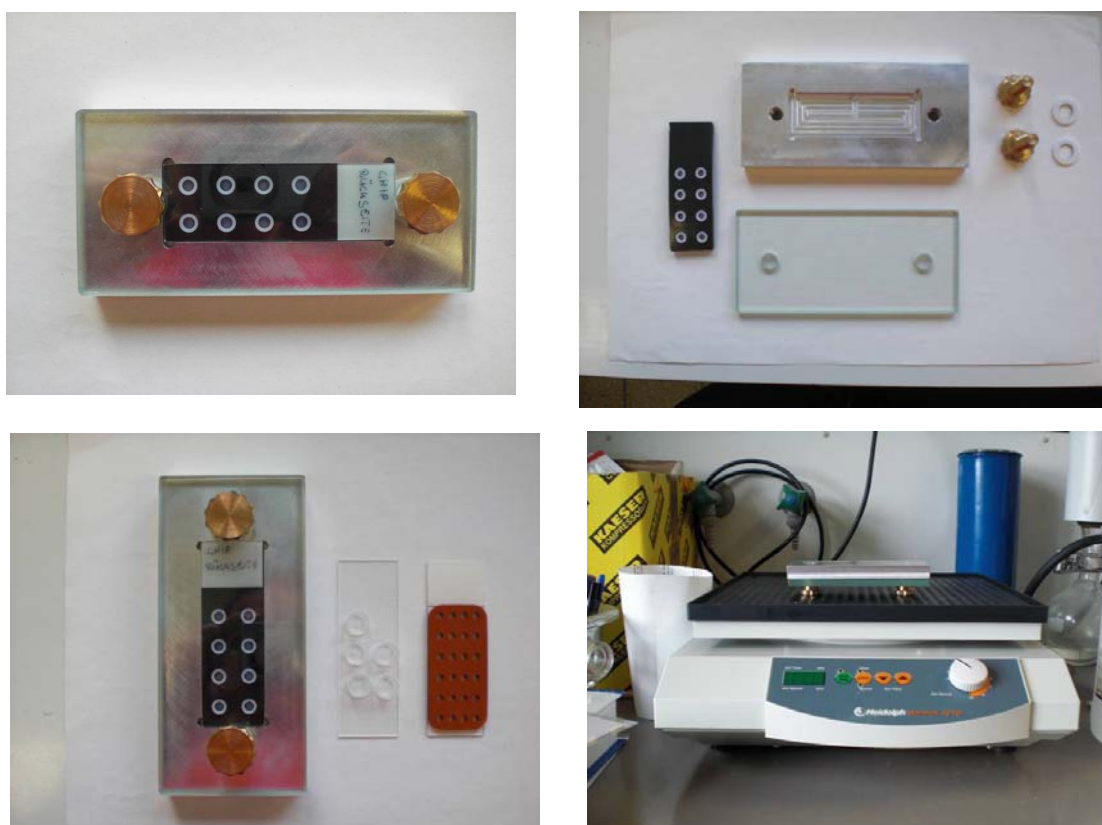
Abb. 3.48: Die neu entwickelte Reaktionskammer MARCO ( multifunctional array reaction chamber for oxazolines ). oben links: Die gesamte zusammengesetzte Reaktionskammer mit einer Maske mit 8 Teflonpfannen und eingesetztem Chip, dessen Rückseite zu sehen ist; oben rechts: die Elemente des MARCO sind hier einzeln zu sehen (von links im Uhrzeigersinn): Die Kunststoffmaske mit 8 Teflonpfannen, die Aluminiumhalterung, die Schrauben und die Glasplatte; unten links: Vergleichende Ansicht der verwendeten Einteilungen des Chips in mehrere Reaktionsräume: Reaktionskammer MARCO , Glasträger mit aufgeklebten Glasringen und Glasträger mit Silikonmaske; unten rechts: MARCO auf einem Horizontalschüttler.
