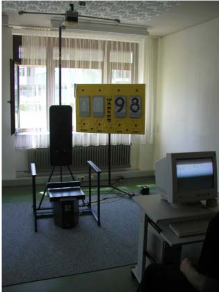
Abb. 4.3: Der Messstuhl ohne Abdeckung
