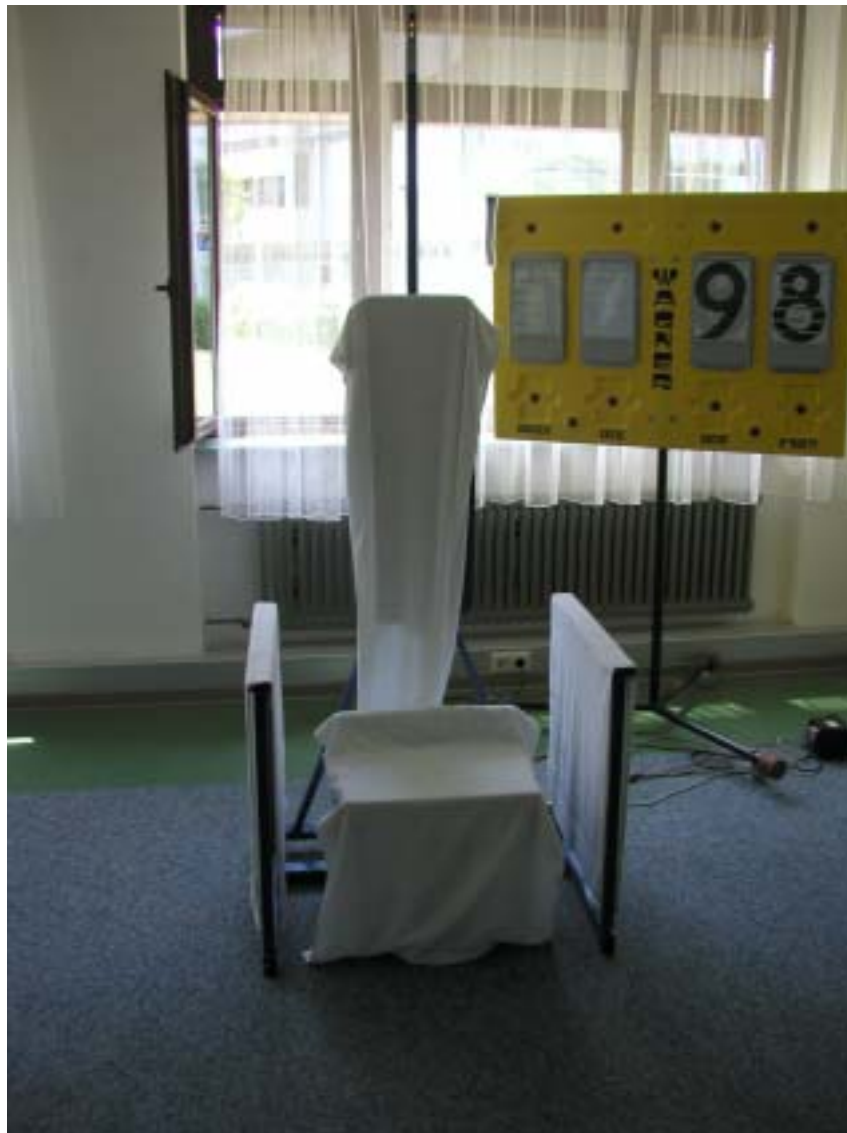
Abb. 4.2: Ein Teil des Messstuhls mit Abdeckung
