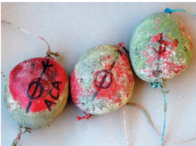
Abb. 8 - Sohltransport: links - geborgene Tracer-Gerölle aus der Station UUHL nach 34 monatiger Expositionszeit; die Oberseiten sind mit einer Kalkkruste überzogen, dennoch sind der Code und die Markierungen deutlich zu erkennen; rechts - im Sediment eingebettete Tracer-Gerölle in der Station KRAH nach 34 monatiger Expositionszeit, nur noch die Markierungsschnüre sind zu erkennen, links daneben das Massband zur Positionseinstimmung. Foto W. Hohl, LAD Bad.-Württ.
