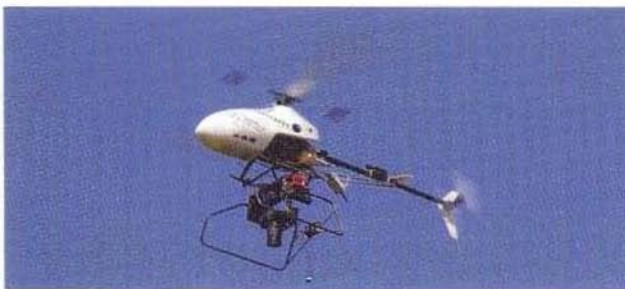
6 Modellhelikopter mit Kameraaufhängung / Helicóptero en miniatura con suspensión para una cámara
